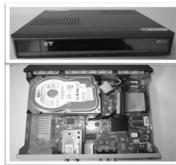
[그림 4] KT의 IPTV 서비스인 메가TV의 셋톱박스과 분해 화면 [Fig. 4] Capture of set-top box and partition in Mega TV(KT)
